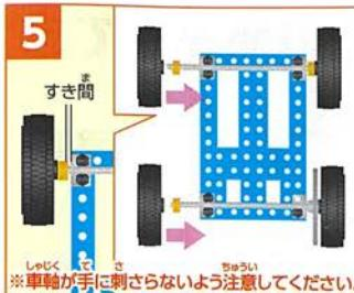
4 車軸にタイヤを取り付けます。
