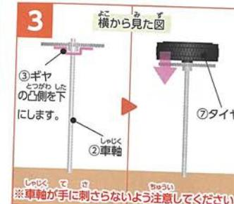
もう1本の車軸には③ギヤを少しだけさし、タイヤを押し込むようにして奥まで取り付けます。
