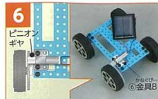
モーターの上に⑥金具Bをかぶせ、⑧ねじと⑨ナットを使って固定します。ピニオンギヤがタイヤとくついついたり、ギヤとはなれたりしないように取り付けてください。
