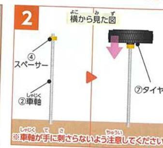
②車軸に④スペーサーを少しだけさし、⑦タイヤを押し込むようにして奥まで取り付けます。
