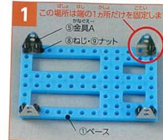
⑧ねじと⑨ナットを使って①ベースの四隅に⑤金具Aを取り付けます。Oの所以外は、ねじとナットを2個ずつ使います。
