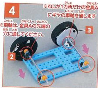
金具Aに②③でつくった車軸を通し、反対側にもスペーサーを取り付けます。
