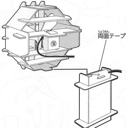
2 モーターと電池ボックスの導線を接続します。
