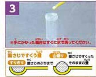
試験管に10mlの水と⑥羹さじの小さい方で、すりきり4杯の②ホウ砂を入れます。
