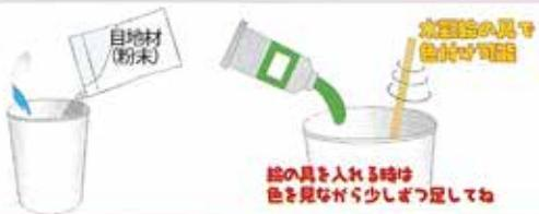
紙コップに水25ccを入れ、そこに目地材を全量入れ、割りばしで1分かき混ぜます。ホイップクリームのようになります。色付き目地材をつくる時は、別容器に取り分けて着色してください。1枚のみ作る場合は、粉末と水の分量は半分にしてください。
