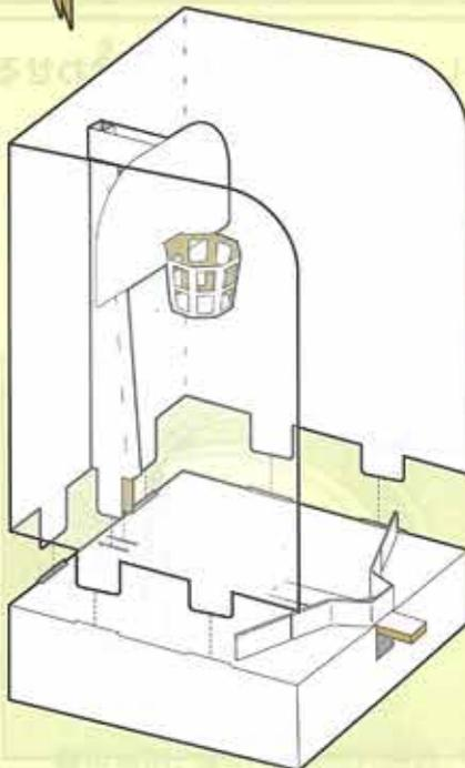
支柱の2カ所のツメと背面ボードの6カ所のツメをステージにさし込む。
