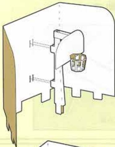
支柱の4カ所のツメを①背面ボードにさし込む。
