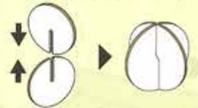
⑬の直線部分に接着剤を付け、ガイドラインにそって2ヶ所折り曲げ、固定し、部品をつくる。
