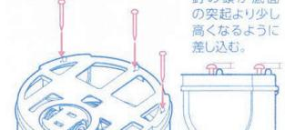
釘の頭が底面の突起より少し高くなるように差し込む。
