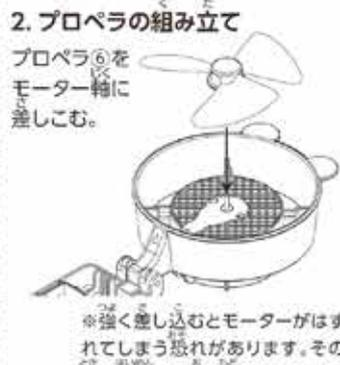
※強く差し込むとモーターがはずれてしまう恐れがあります。その時は背面から押し戻してください。
